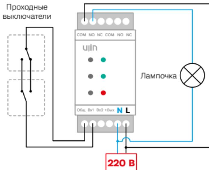
Управляемые нагрузки можно подключать к устройству либо по нормально-замкнутой схеме, либо по нормально-разомкнутой схеме.
